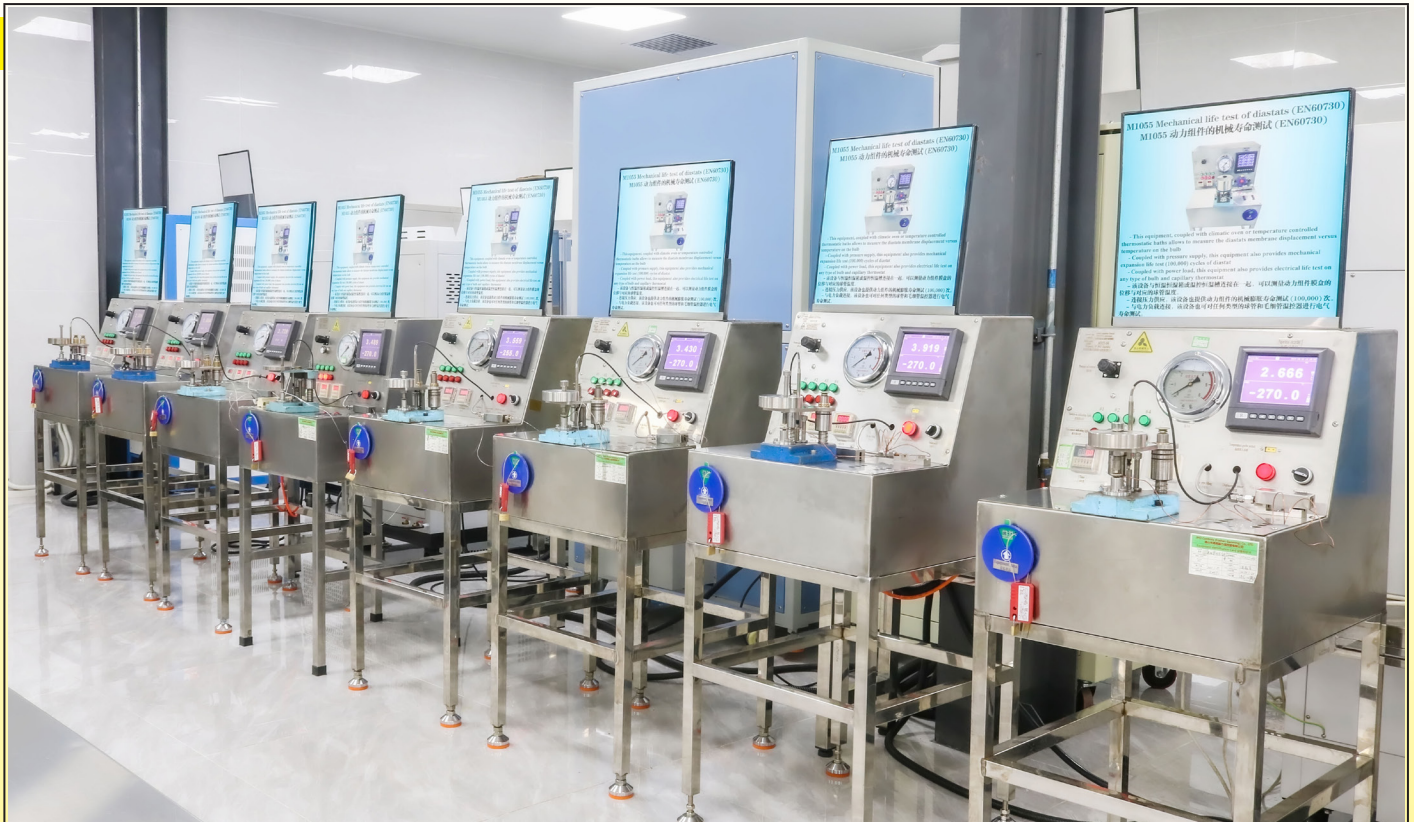
Conjunto de equipos automáticos de prueba de vida mecánica de diastatos. Cada equipo está equipado con un registrador de datos de los parámetros de prueba y el número de ciclos. (Laboratorio Ultimheat).
